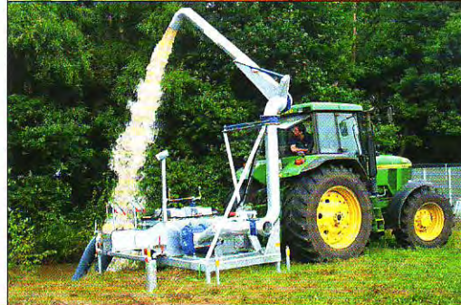
Leistungsfähige Fassfüllstation für den Profieinsatz (13 000 l/min).
