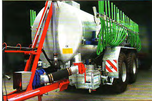
VX Drehkolbenpumpe, RotaCut MXL und SwingMax- Schleppschlauchgestänge: die Kombination für professionelle Gülleausbringung.
